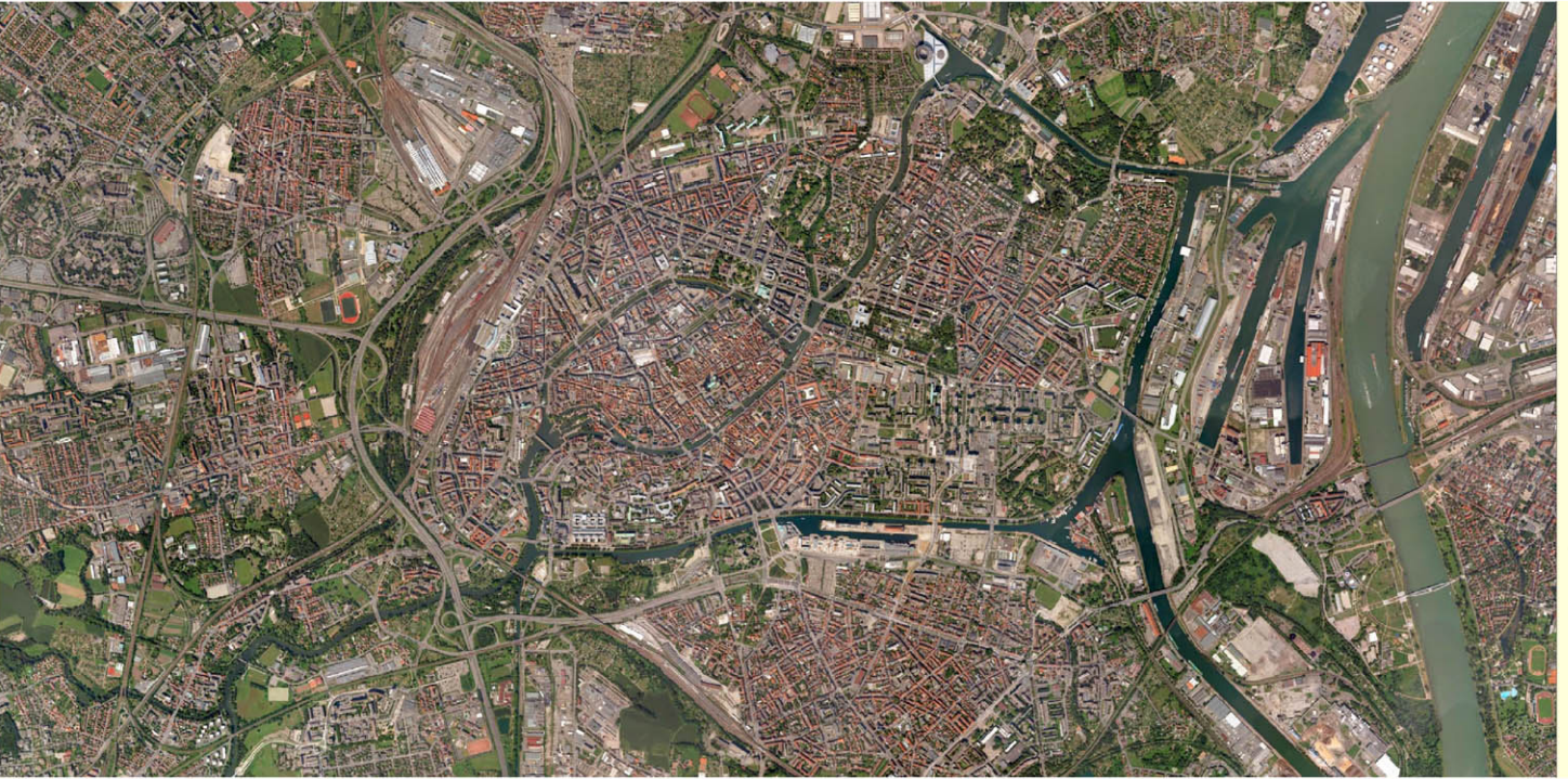
BD Ortho - niveau 6 : résolution 512 cm, échelle 1/32 000
