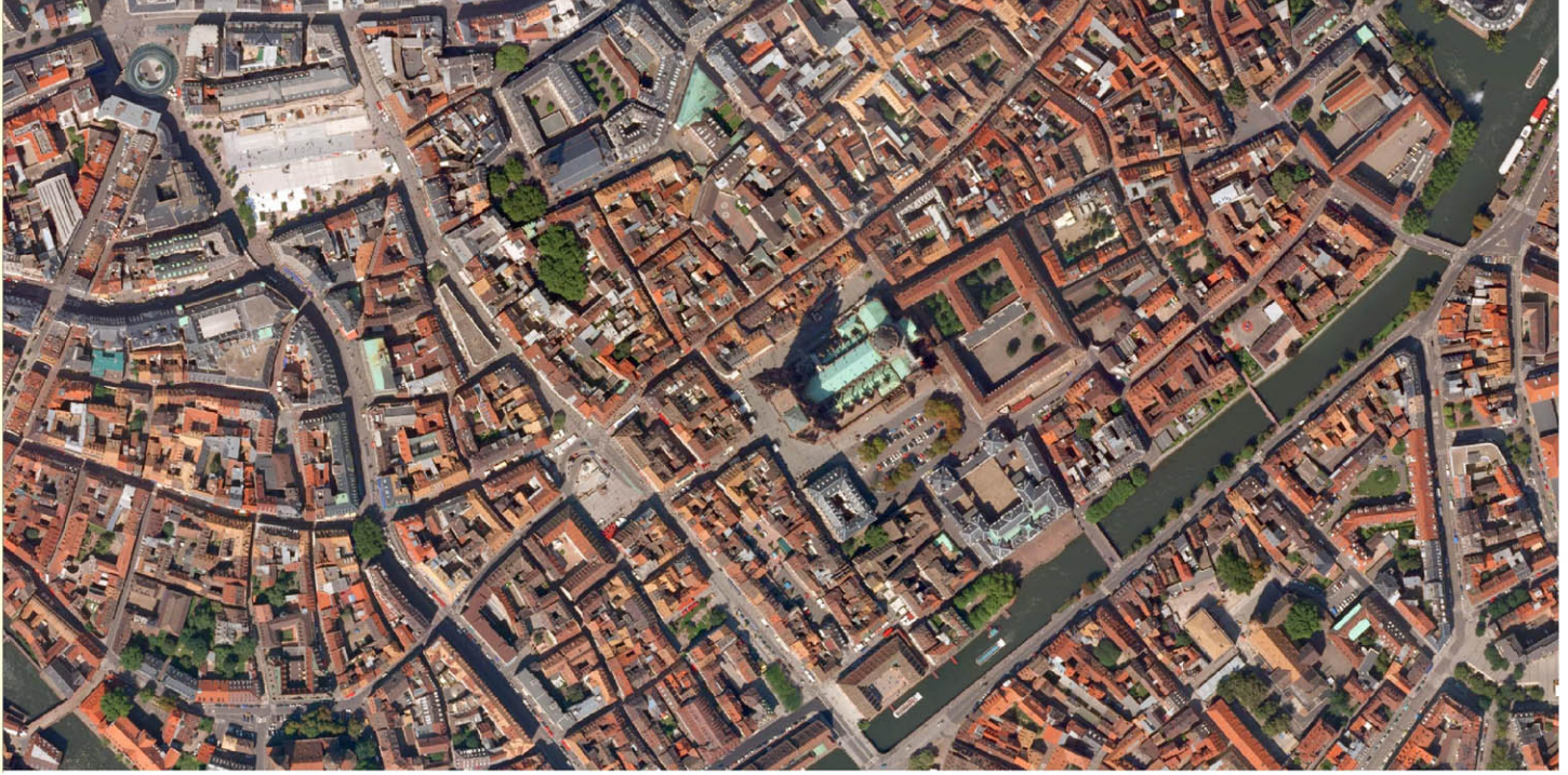
BD Ortho - niveau 3 : résolution 64 cm, échelle 1/4 000
